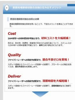
一般的に、鉄やSUSなどの鋼板は溶接がしやすく、スポット溶接、アーク溶接そしてファイバーレーザー溶接などの多様な接合が可能です。しかし、表面処理鋼板材の接合の中でも特に目付量が多い溶融亜鉛メッキ鋼板など、表面処理が施された鋼板における溶接は、接合不良の発生リスクが高く、高難度とされています
